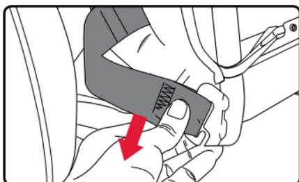
3. Pase el extremo del arnés a través de la abertura en el interior de la barra de metal detrás del anclaje en la parte inferior del asiento.
